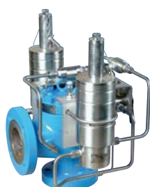
SERIE 76 ASME Раздел VIII API RP 520 – Std 526 ISO 4126 Длинное седло Управление: пруж. или модуль. Ввод: от 1" до 12" Уст давл: до 431 бар (изб.) Темп.: от -196°C до +260°C Мат.: Сталь – Нерж. сталь – Спец. сплавы
