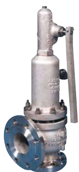
Starflow ASME Раздел VIII API RP 520 – Std 526 ISO 4126 Длинное седло Ввод: от 1" до 12" Уст давл: до 414 бар (изб.) Темп.: от -196°C до +540°C Мат.: Сталь – Нерж. сталь – Специальные сплавы
