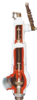
SERIE 9 ASME Раздел VIII API RP 520 – ISO 4126 Длинное седло Ввод: от 1/2" до 11/2" На резьбе – На фланцах – Ввариваемый – На защелках Уст давл: до 414 бар (изб.) Темп.: -196°C à +400°C Мат.: Сталь – Нерж. сталь – Специальные сплавы
